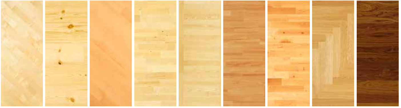
Beliebte Parkettarten in der Schweiz: Ahorn, Kiefer, Buche, Birke, Esche, Kirschbaum, Erle, Eiche, Nussbaum.
